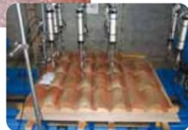
「瓦屋根標準設計・施工ガイドライン」に準拠した150回繰り返し引き上げ試験で3528N/m<sup>2</sup>の荷重で合格しております。これは要求される風圧力が最も高い沖縄県でも安心して採用していただける性能です。(沖縄県(粗度区分Ⅲ、平均高さ10m、平部)風圧力:2001N/m<sup>2</sup>)
